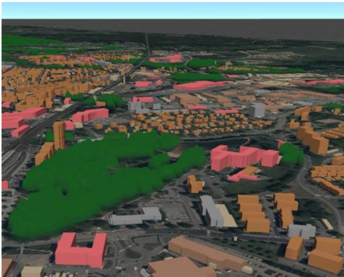
3D-vy över Skövde med Lantmäteriets flygbilder draperade på den nationella höjdmodellen. Byggnader och skog från GSD-Fastighetskartan höjdsatta med hjälp av ytmodell från laserdata. Byggnaderna är färgsatta efter ändamål, bland annat bostäder och industrier.
