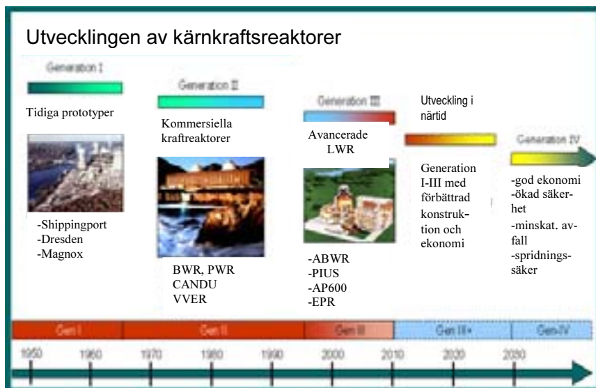
Figur 8.7. Reaktorutvecklingen t.o.m. den planerade fjärde generationen av reaktorer.
