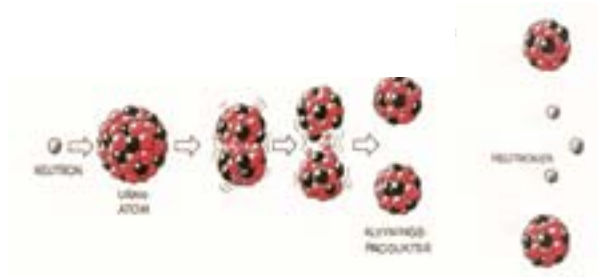
Figur 8.2. Schematisk beskrivning av klyvningsprocessen (fission). En neutron infångas av en uranatom, som exciteras och klyvs (fissionerar) i två delar (klyvningsprodukter). Samtidigt avges ett antal neutroner.
