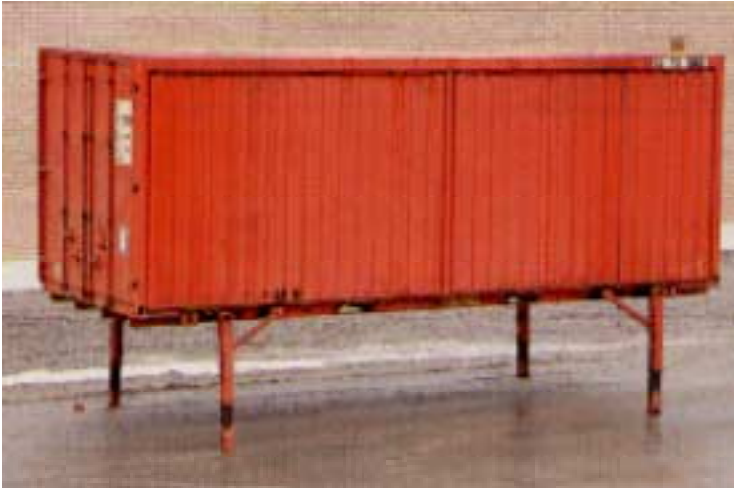
Bild 1. Växelflak med stödben och påbyggnad.
