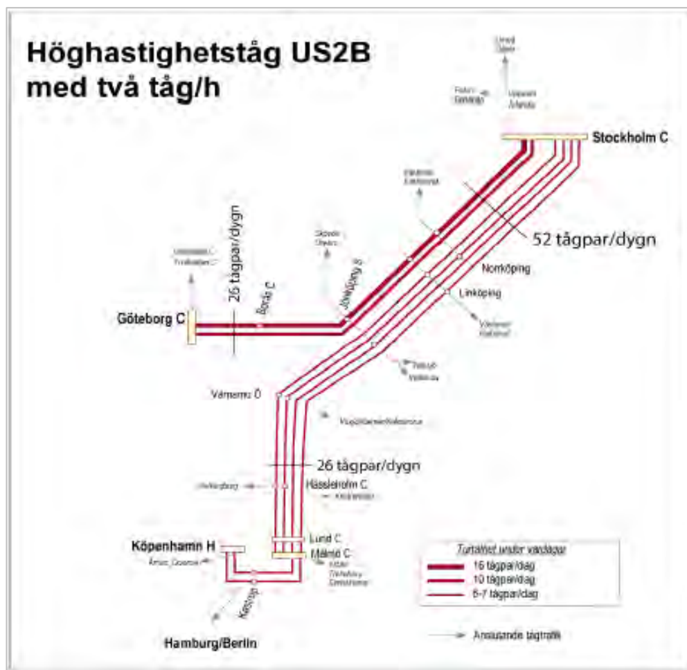
Figur 2 Trafikverkets trafikmodell för kommersiella höghastighetståg med dragning via Värnamo US2B. Tågstopp i Värnamo varje timme och Jönköping Södra varje ½ timme. Restiderna blir i detta system extremt korta med få stopp undervägs och toppfart 320 km/h.
