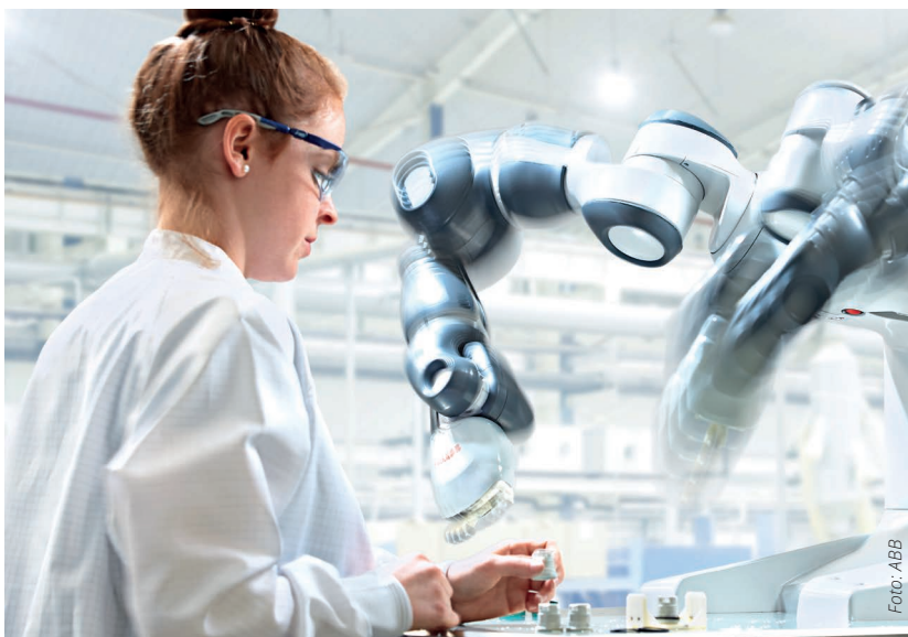
En ny epok av industrirobotar som kan arbeta sida vid sida med människor inom framförallt olika former av småkomponentmontering och materialhantering inleds med ABB:s YuMi, en industrirobot som är utvecklad för ett nära samarbete med människor.
