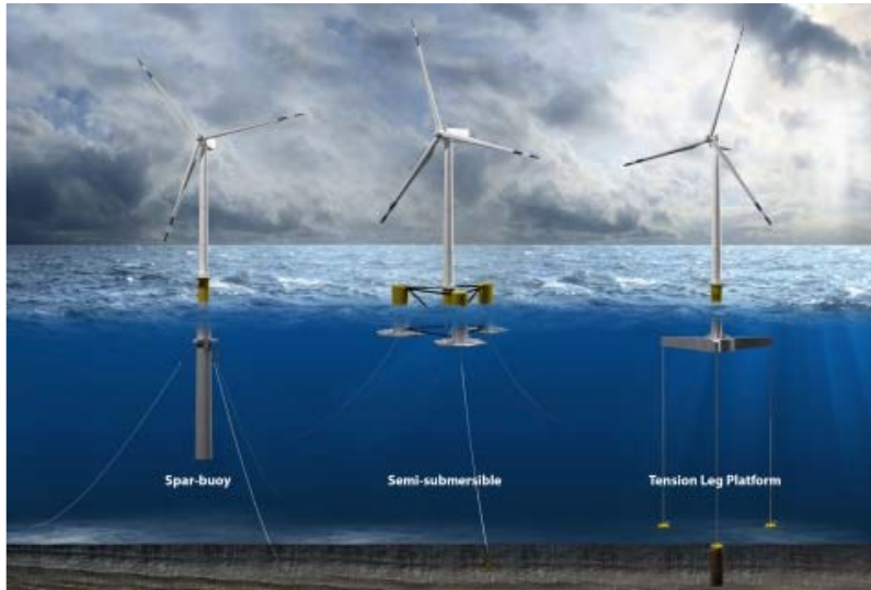
Figur 5.1 De tre huvudtyper av flytande plattformar. Källa: Carbon Trust 2015 42
