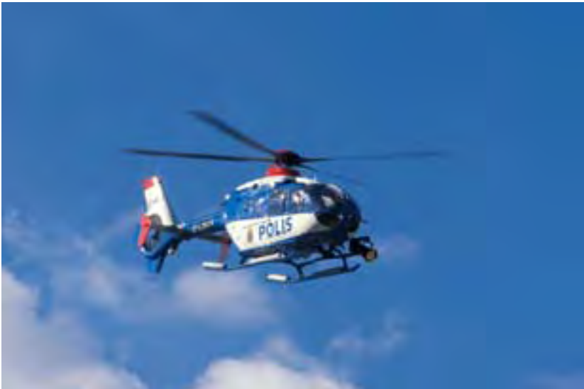
Lätt helikopter med två turbinmotorer, EC 135 hos Polisflyget. Foto: Andreas Karlsson - Försvarets Bildbyrå.
