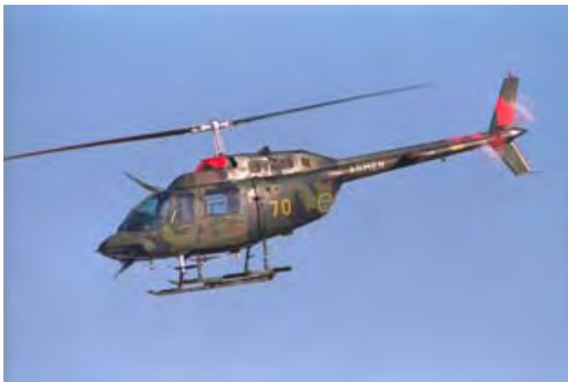
Lätt helikopter med en turbinmotor, Agusta Bell 206, HKP 6.
