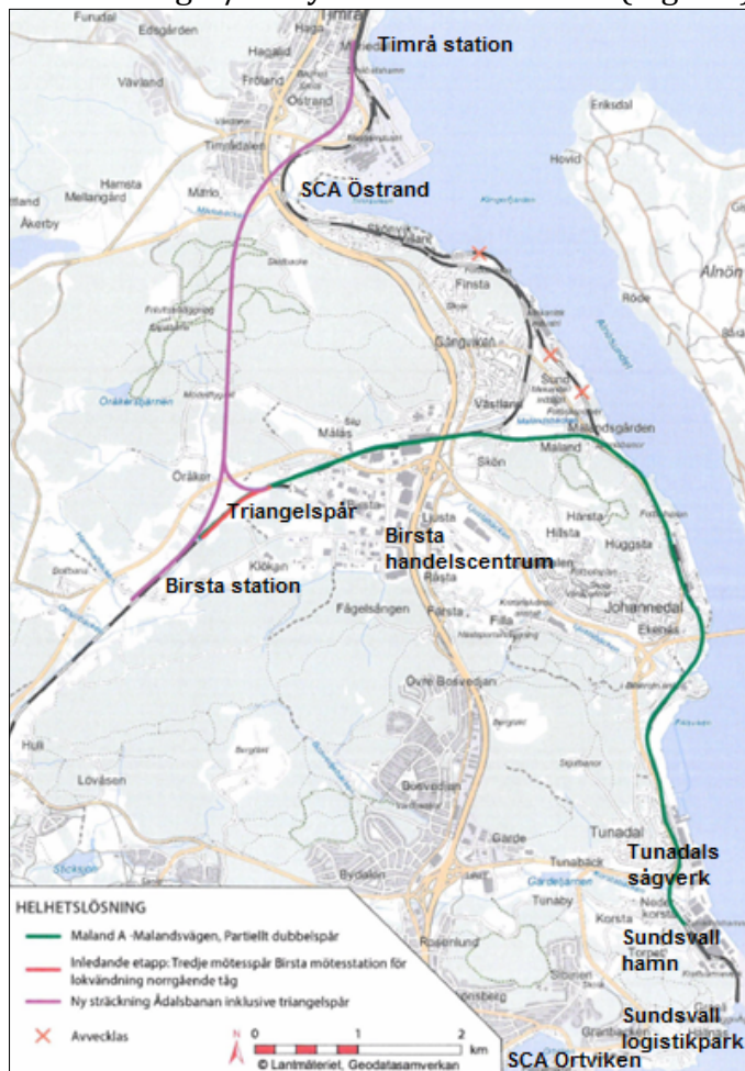
Figur 6. Etappen Birsta-Timrå på Ådalsbanan i lila sträckning samverkar med Malandstriangeln och Tunadalsspåret för att skapa en effektiv lösning för godstrafik till och från Sundsvalls logistikpark/hamn och de stora industrierna vid Tunadal.
