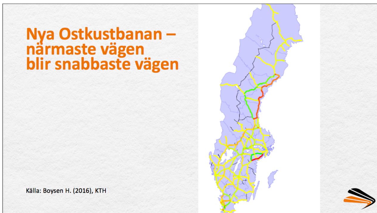
Figur 17. Nya Ostkustbanan innebär den största potentiella förkortningen av godstransporter i landet genom att man undviker omledning via Norra stambanan. Ju rödare sträcka desto fler tåg per dygn får förkortad transportväg. Källa: Boysen (2016).
