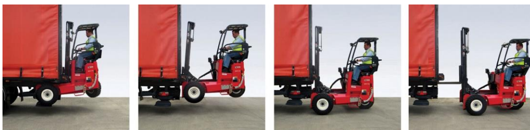
Bilder: Påhängstruck för lastning ock lossning som hänger längs bak på fordon tillåts utöver fordonslängd i flera länder t.ex. Finland och Danmark.
